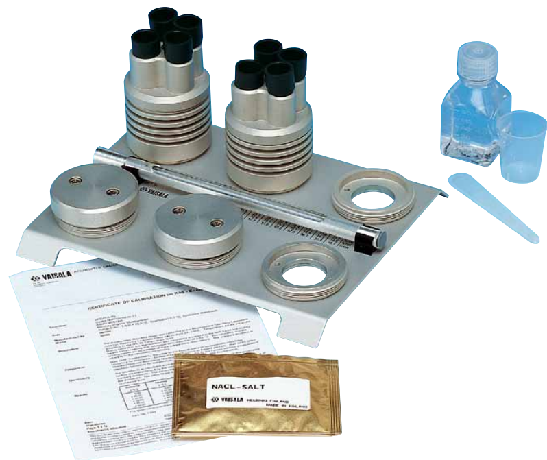
Vaisala Humidity Calibrator HMK15 – een voorbeeld van een apparaat met verzadigd zoutbad.
