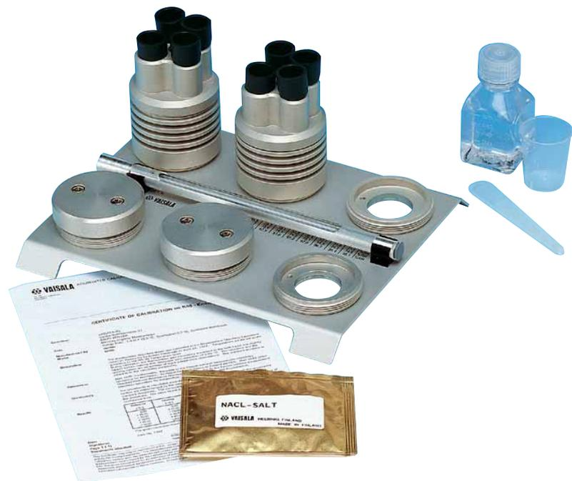
Étalon d'humidité Vaisala HMK15 – exemple d'appareil à solution saline saturée.
