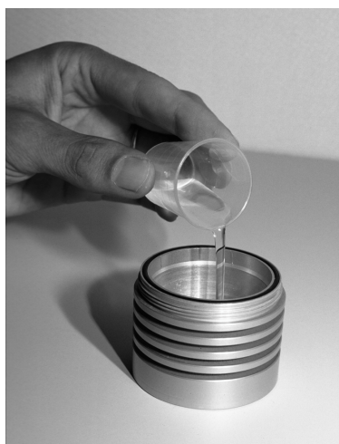
図 2.2 イオン交換水は液量を正確に量り、校正用ボトルに注ぐ。計量カップの水気は必ず拭き取ってください
