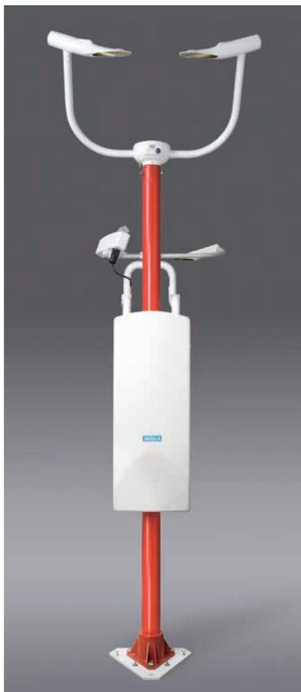
ヴァイサラ 現在天気計 FS11Pは、滑走路視程 (RVR)、航空視程および総観視程、現在天気観測など、さまざまな苛酷な航空気象用途向けに設計されています。FS11Pは、視程、および現在天気センサが組み込まれており、貴重なマルチパラメータの測定値を1つにまとめて提供します。最長75kmの視程、降水タイプと強度を網羅した現在の天気、およびオプションで背景輝度に関するデータを送信します。
